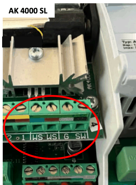
AK 4000 SL: bornele WS, WS, G, SW ale sondei Lambda
