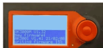
Afișajul AK3000 în pașii 6 – 7: alegerea cardului SD, opțiunea „firmware” și încărcarea firmware-ului
