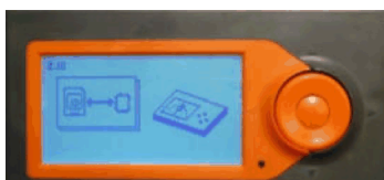
Afișajul AK3000 în pașii 6 – 7: alegerea cardului SD, opțiunea „firmware” și încărcarea firmware-ului
