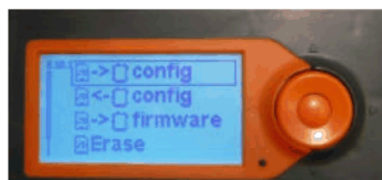
Afișajul AK3000 în pașii 6 – 7: alegerea cardului SD, opțiunea „firmware” și încărcarea firmware-ului
